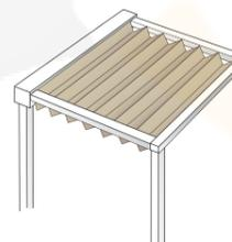
En la pérgola el motor se para automáticamente cuando alcanza la posición de máxima extensión: para memorizar el fin de carrera basta con seguir la secuencia correspondiente desde el emisor. Desde este momento el motor cada vez que alcanza la posición de fin de carrera de apertura se para manteniendo la lona siempre en tensión.
