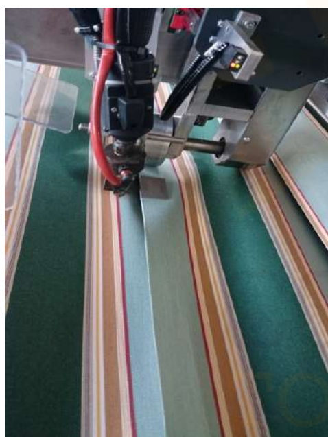
Corte de lona mediante máquina de ultrasonidos
