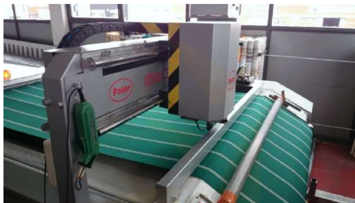
Corte de lona mediante máquina de ultrasonidos
