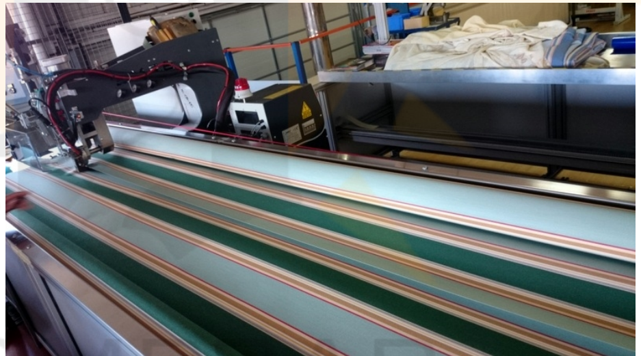
Unión de las tallas mediante máquina de pegado especial. Termosoldado, mejor calidad, mayor duración de la lona.
