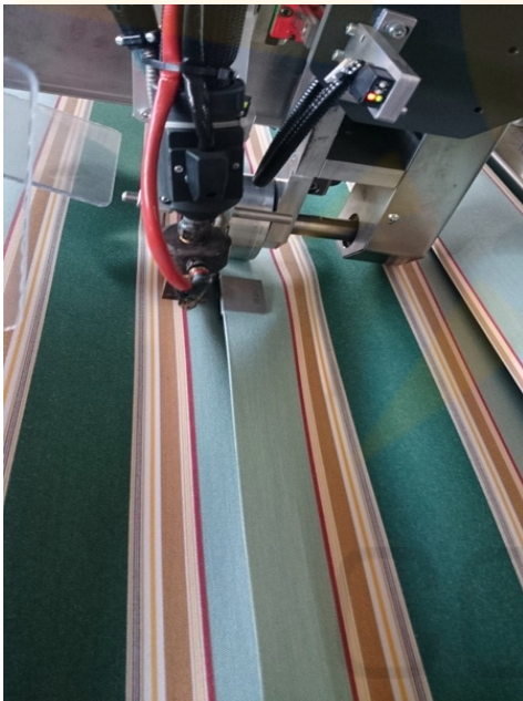
Corte de lona mediante máquina de ultrasonidos
