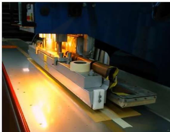
Soldadura de lonas por alta frecuencia, con varias medidas de electrodos.
