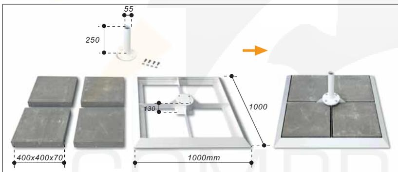
**BASE LASTRE.** Este accesorio se utiliza en lugares donde no está permitido perforar el pavimento. Su peso montado es de 100Kg aprox. y se compone de un marco estructural, un soporte pletina circular,
